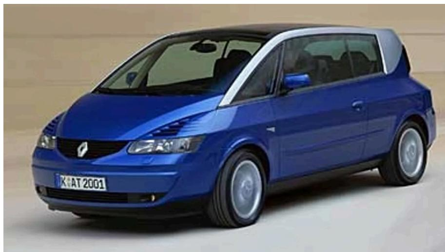
Dieses zweitürige „Van-Coupe“ mit luxuriöser Ausstattung war auf Basis des Espace der dritten Generation im Matra-Prinzip gefertigt - Stahlgerüst und GFK-Aussenhaut - und hatte eine sehr aufwändige Technik für die Scharniere der recht grossen und schweren Türen.
