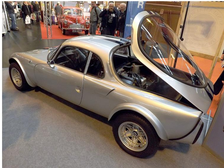
Als Basis nahm Bonnet das von ihm konstruierte Formel-3-Chassis mit dem Antrieb der Alpine - bei der dieser Motor im Heck montiert war - und machte daraus einen zweisitzigen Mittelmotor-Sportwagen.
