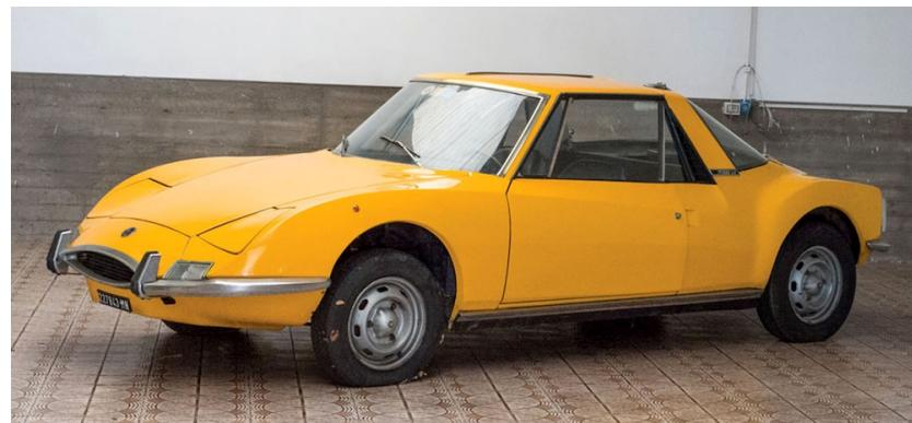
Wie der Djet war es ein kleines Coupe/Sportwagen mit Mittelmotor und GFK-Karosserie. Das abnehmbare Dach konnte im Kofferraum verstaut werden.
