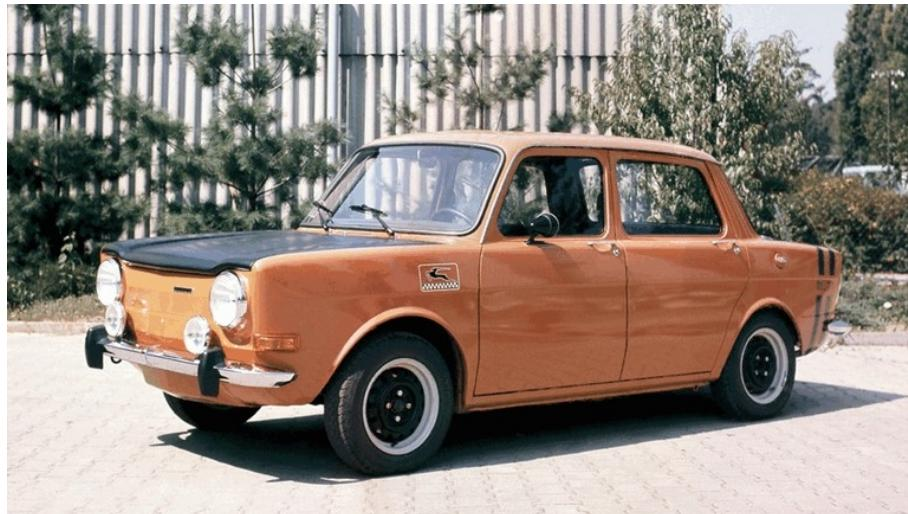
Ab 1972 als Rallye 2 in der Geschmacksnote „spicy“ mit über 80 PS, Scheibenbremsen an allen vier Rädern und einem an die Front versetzten Kühler zur besseren Gewichtsverteilung. Später wurde die Motorleistung auf 86 PS angehoben.
