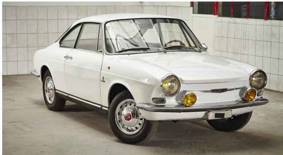
Ab 1967 bekam das Coupé einen Motor mit 1200 ccm und eine neue Front, da der Wasserkühler an die Wagenfront verlegt wurde.
